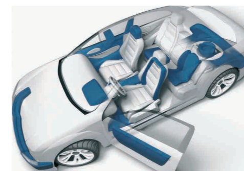
Vue d'ensemble des garnitures en PPE
